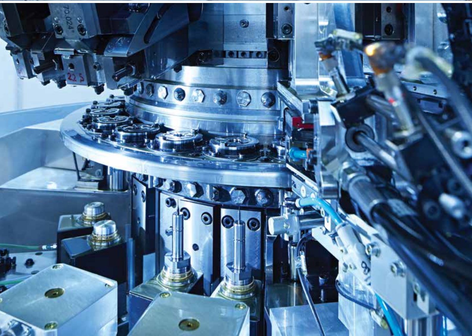
Mikron Multistar NX-24: до 44 обрабатывающих устройств, работающих одновременно на 24 позициях, обеспечивают очень высокие объемы производства.
